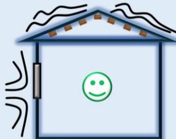
Rendre étanche à l'air extérieur, freiner la vapeur intérieure et vérifier l'état de la charpente
